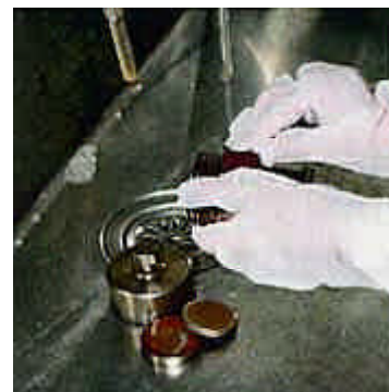
写真D-1.21 ステンレス耐圧容器の洗浄
