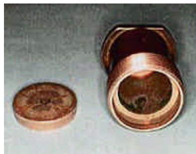
写真D-1.11 破損したステンレス耐圧容器
