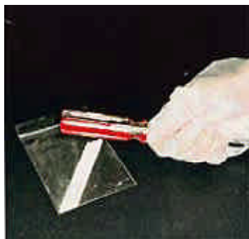
写真D -2.4 ドライバーによる破碎
