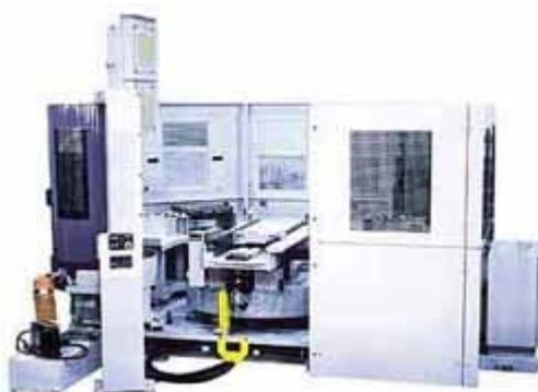
写真 3.2 パレットチェンジャーシステム 提供：KAWATEC CORP.
