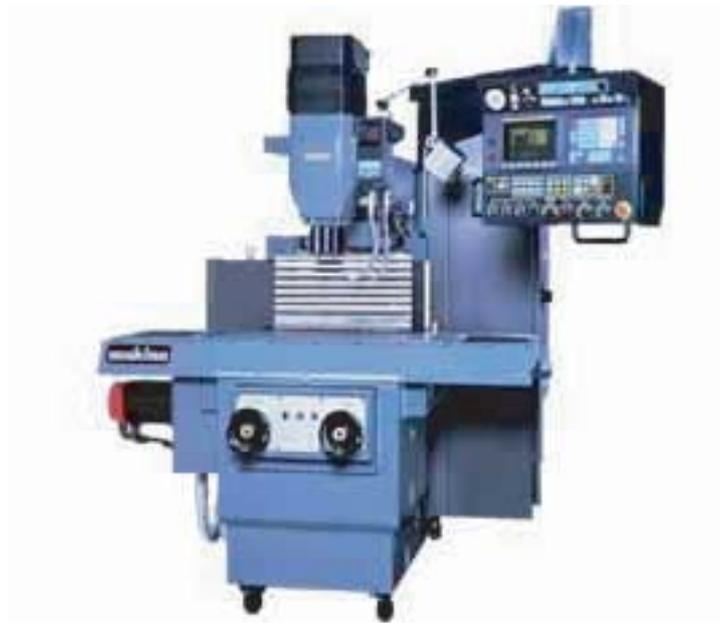
図1.18 NCフライス盤例（出典先：牧野フライス製作所）
