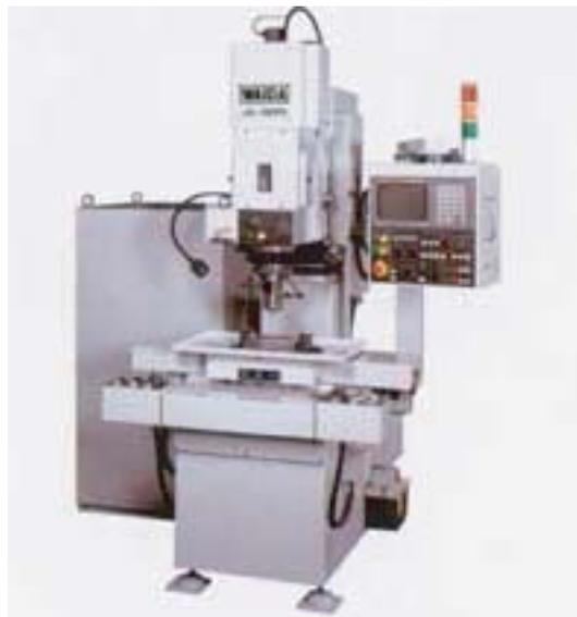
図1.23 CNC同時4ジグ研削盤例（出典先：和井田製作所）
