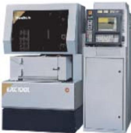
写真3.5 ワイヤによる小形精密加工用放電加工機
