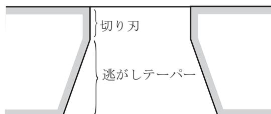
図3.45 ストレートの切り刃のあるダイ形状
