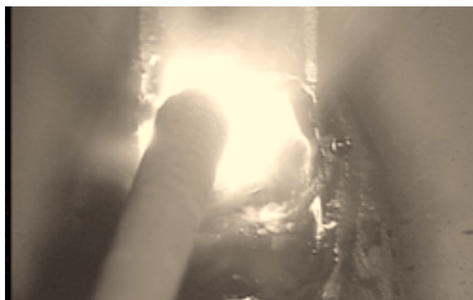
写真35：仕上げ層中央部の溶融池外観 (A-2V)
