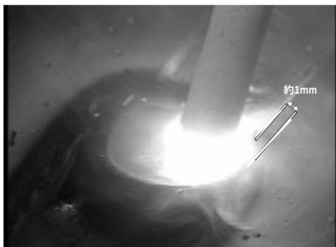
写真23：仕上げ層の溶融池外観 (A-2F)
