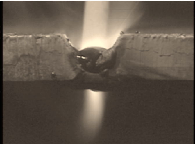
写真64：アークの開先裏側への抜け状況（N－2F）
