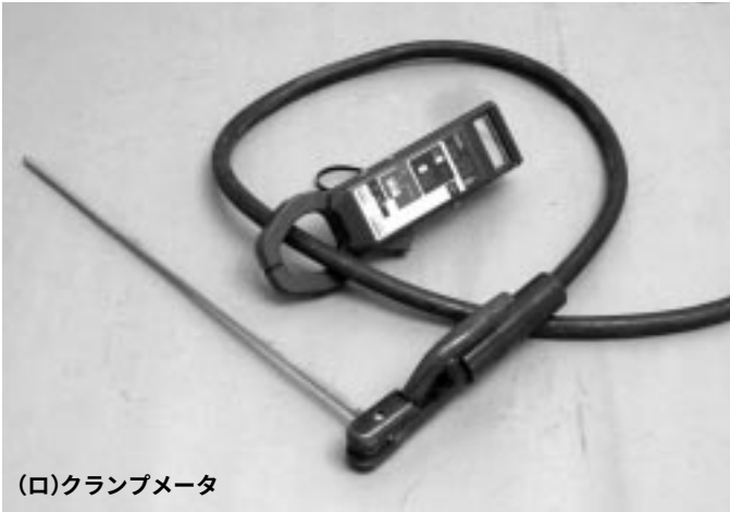
写真2、3：交流溶接機における溶接電流の測定
