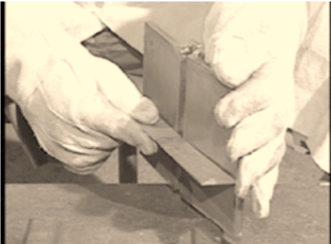
写真17：角度ゲージによる逆ひずみの調整
