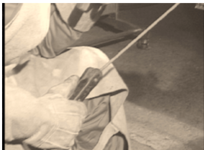
写真29：溶接棒ホルダの保持状況
