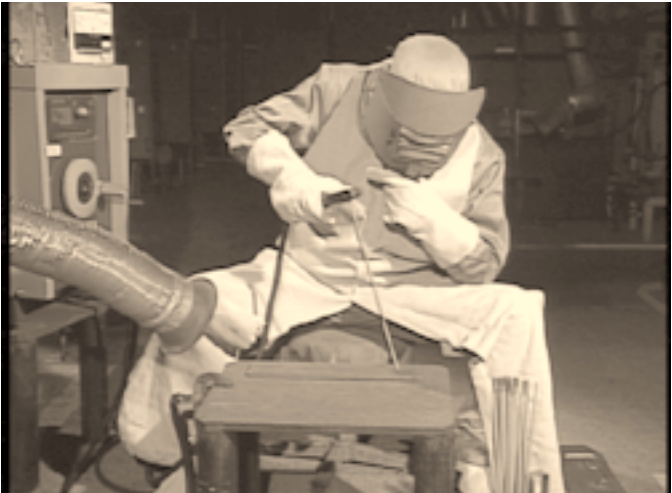
写真10：下向溶接における作業姿勢
