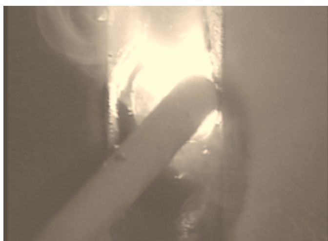
写真32：2層目溶融池の外観 (A-2V)
