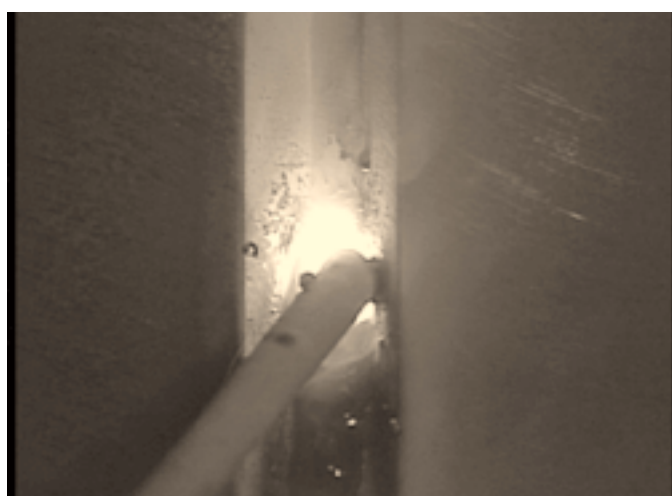
写真30：1層目溶融池の外観 (A-2V)
