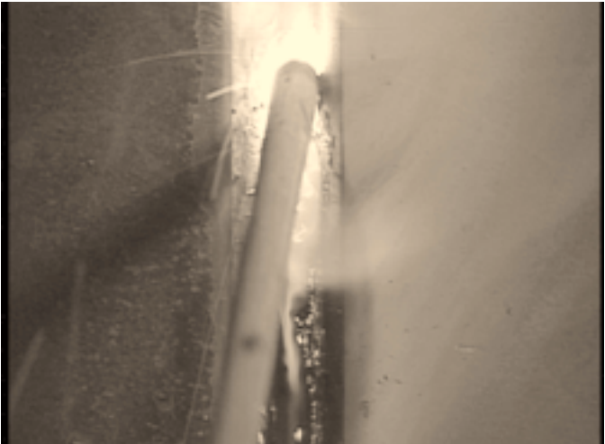
写真41：イルミナイト系によるウィッピング運棒による跳ね上げ後の1層目溶融池外観 (A-2V)
