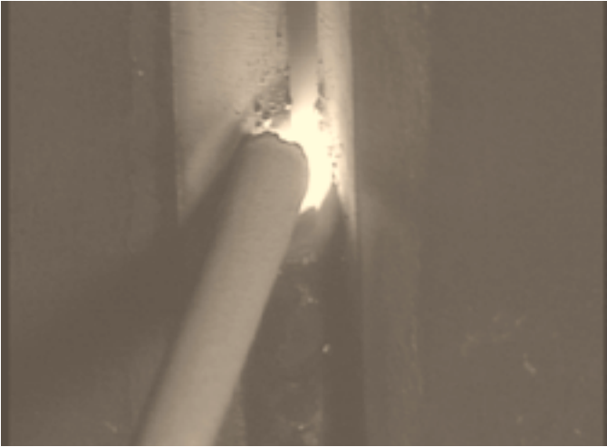
写真66：1層目(裏波溶接)溶融池の外観 (N-2V)
