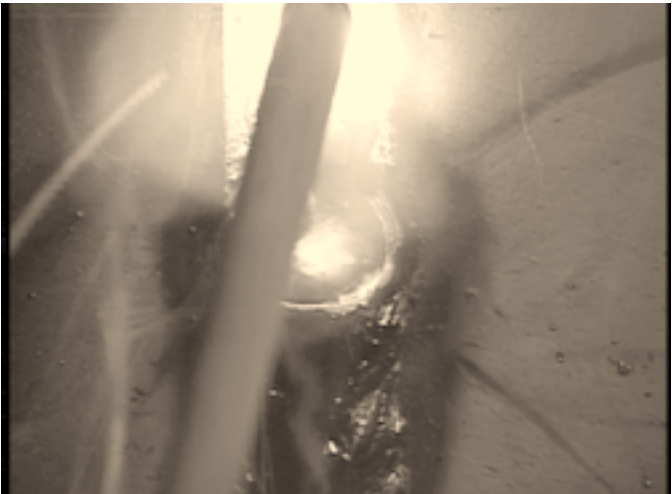
写真43：イルミナイト系によるウィッピング運棒による跳ね上げ後の仕上げ層溶融池外観 (A-2V)
