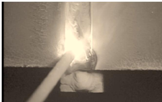
写真34：仕上げ層ビードスタート部の溶融池外観 (A-2V)
