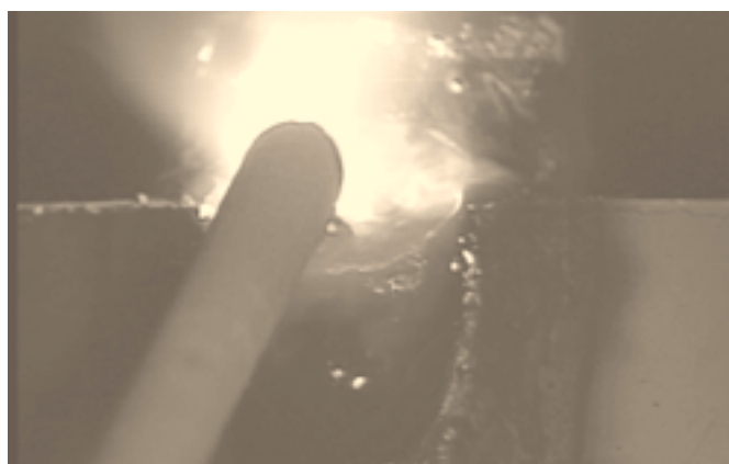
写真36：仕上げ層ビード終端処理 (A-2V)
