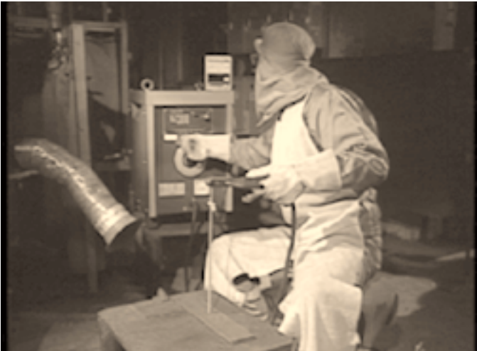
写真8：短絡電流の測定状況
