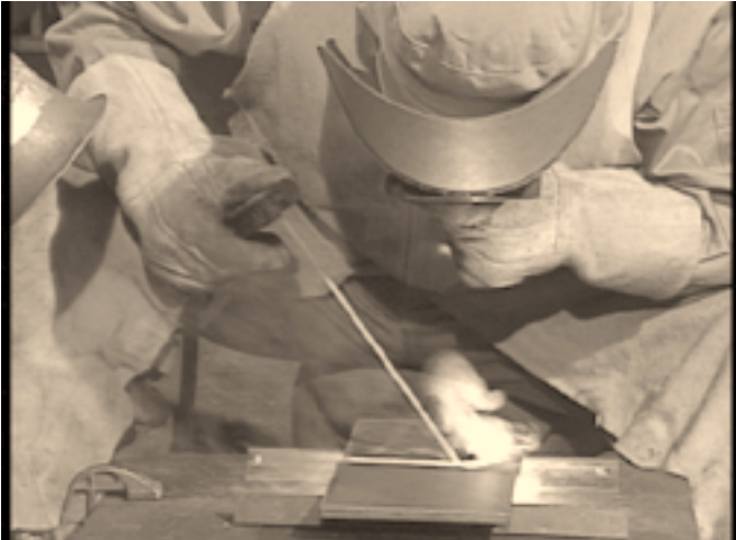
写真62：1層目（裏波溶接）の溶接棒保持角度（N－2F）
