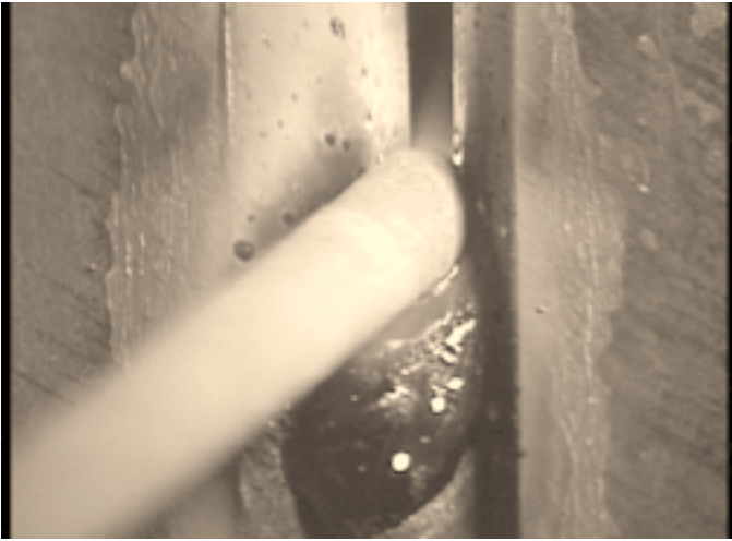
写真69：1層目ビード継ぎ部の運棒法 (N-2V)
