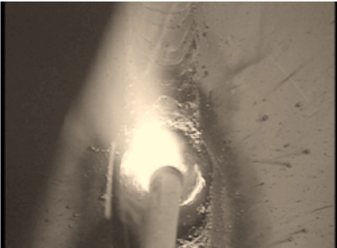
写真42：イルミナイト系によるウィッピング運棒による跳ね上げ前の仕上げ層溶融池外観 (A-2V)
