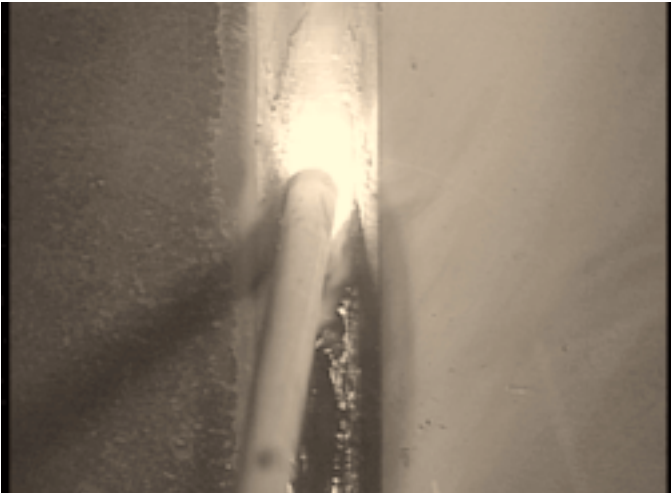
写真40：イルミナイト系によるウィッピング運棒による跳ね上げ前の1層目溶融池外観 (A-2V)
