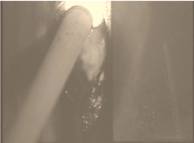
写真38：イルミナイト系1層目溶融池の外観 (A-2V)
